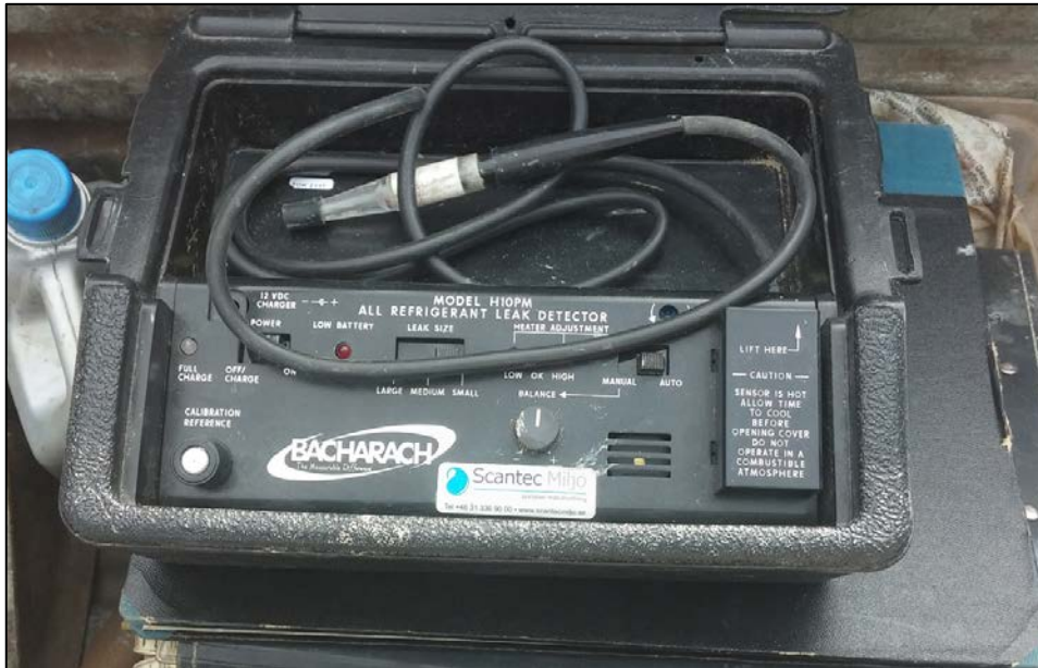
Figur 12. HDI-mätare för registrering av halogenerade kolväten.
